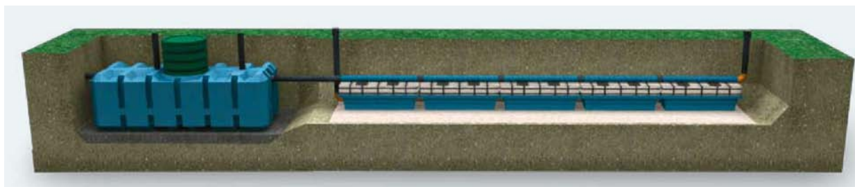
Pasívna čistička FANN IN DRÄN Plus (vsak vyčistenej vody do podlažia)
